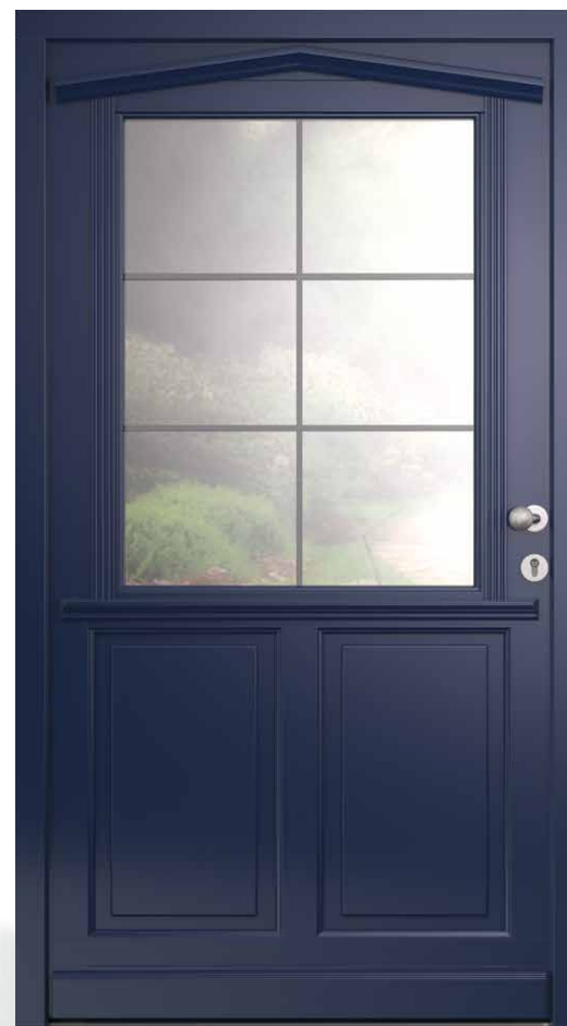
AH 94819 • Rahmenkonstruktion • Holzart Kiefer • Stahlblau RAL 5011 • Karniesprofil am Flügel • glasteilende Sprossen 98mm und 78mm • Aufbauprofile im Glasfeld • Verglasung mit Bleisprossen • Brüstungsplatten außen mit flachen Kassetten • S2150 Edelstahl-Knauf
