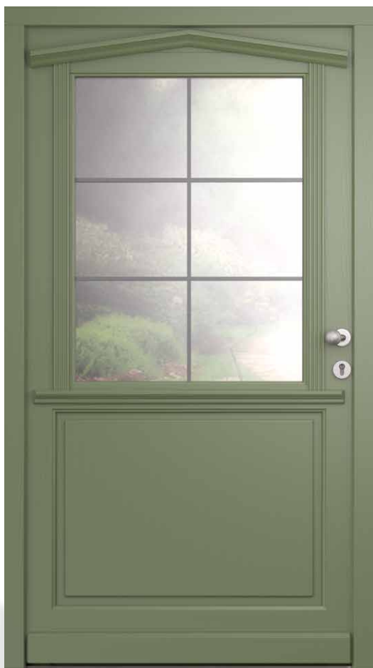
AH 94809 • Rahmenkonstruktion • Holzart Kiefer • Resedagrün RAL 6011 • Karniesprofil am Flügel • glasteilende Sprosse 98 mm • Aufbauprofile im Glasfeld • Verglasung mit Bleisprossen • Brüstungsplatte außen mit flacher Kassette • S2150 Edelstahl-Knauf
