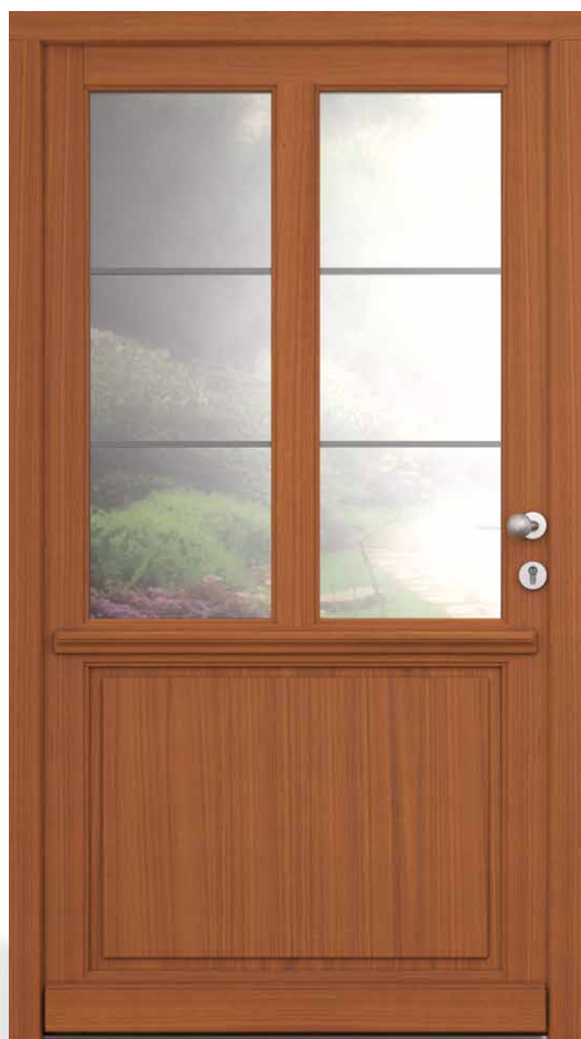
AH 94319 • Rahmenkonstruktion • Lasur Douglasie 324 • Karniesprofil am Flügel • glasteilende Sprossen 98mm und 78mm • Verglasung mit Bleisprossen • Brüstungsplatte außen mit flacher Kassette • S2150 Edelstahl-Knauf + Zusatzausstattung: Holzart Eucalyptus globulus
